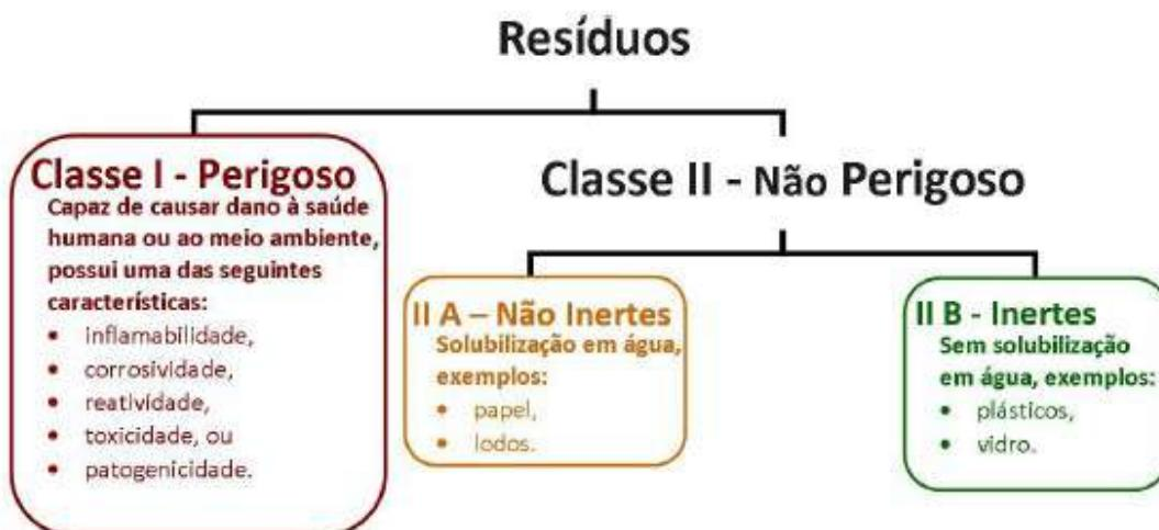
Figura 1. Classificação dos resíduos segundo a NBR 10.004:2004.
