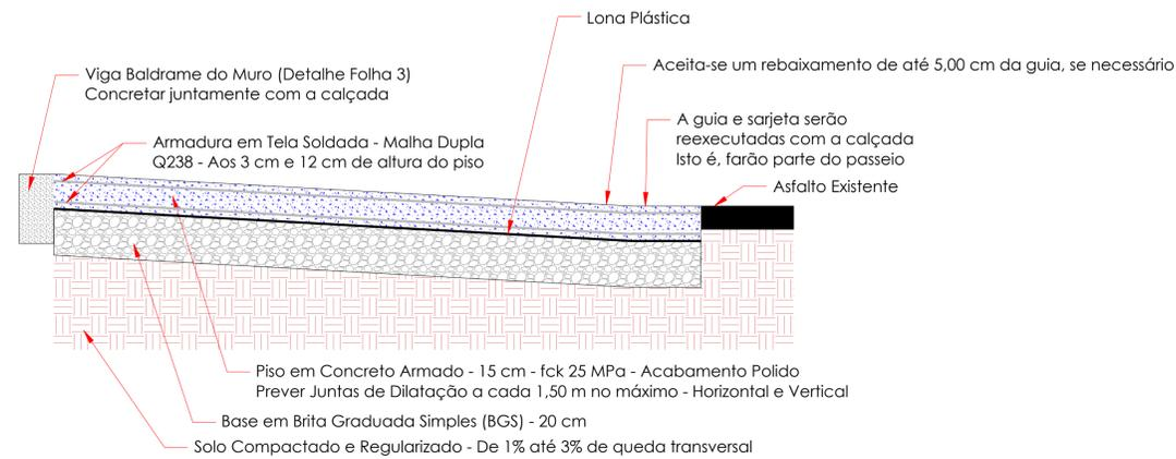
Detalhe Tipo - Calçada para Passagem de Veículos Sem Escala
