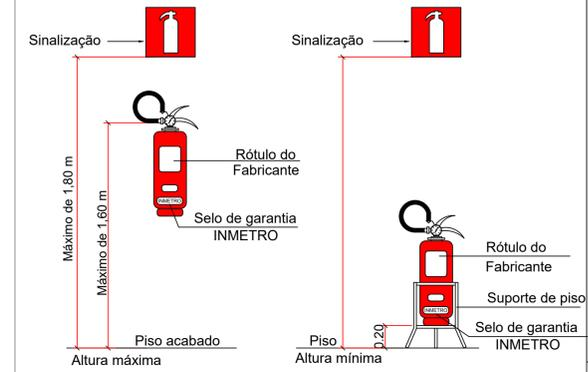
POSICIONAMENTO DOS EXTINTORES SEM ESCALA
