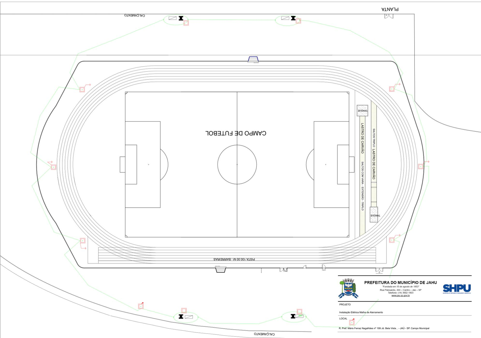
Todos os Aterramentos deverão ser interligados ao BEP. Em cada caixa de passagem com poste metálico deverá haver uma haste de aterramento. Deverá ser utilizado cordoalha de aço galvanizado à quente 80 mm<sup>2</sup>, enterrada a 0,75 m. As ligações das hastes com a malha de aterramento devem ser através de solta exotérmica. Todas as partes metálicas devem estar aterradas (caixa d'água e alambrados).
